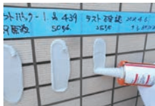
グラウトパック®-439 乾燥後 グラウトパック®-1 のテストシール
