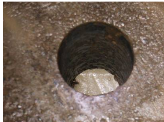
写真 確認孔の下を流動して通過するフィルコンライト All in One
