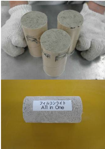
写真上: 上面を均した円柱供試体と脱型後の状況 写真右: ひずみ制御式土の一軸圧縮試験
