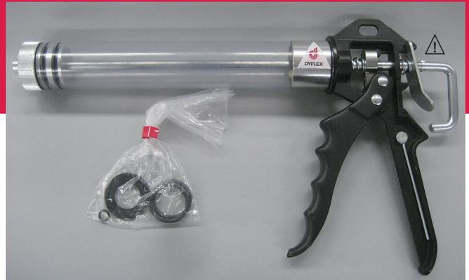
⚠️ プラグの注入口からポンプを外す際は必ずバックレバーを押し、少しピストンロッドを引いた状態で外して下さい。
