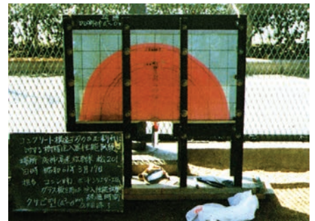
注) ひび割れ幅は一定とする。1回に注入される樹脂量は40c.c.(46g)とする。注入樹脂は、同心円状に拡がるものとする。
