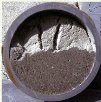
エアモルタル
