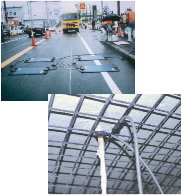
補強前後の既設鉄筋の実応力度の変化
