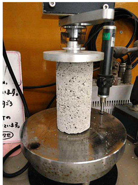
写真上: 上面を均した円柱供試体と脱型後の状況 写真右: ひずみ制御式土の一軸圧縮試験
